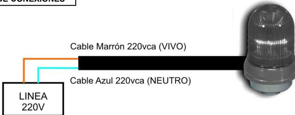
La conexión se realiza a través de un par de cables envainados de colores estandar para alimentación en líneas de 220vca, un cable **MARRON** que se conecta al **VIVO**, y un cable **AZUL** que se conecta al **NEUTRO**, siendo la alimentación de **220v de corriente alterna**.
