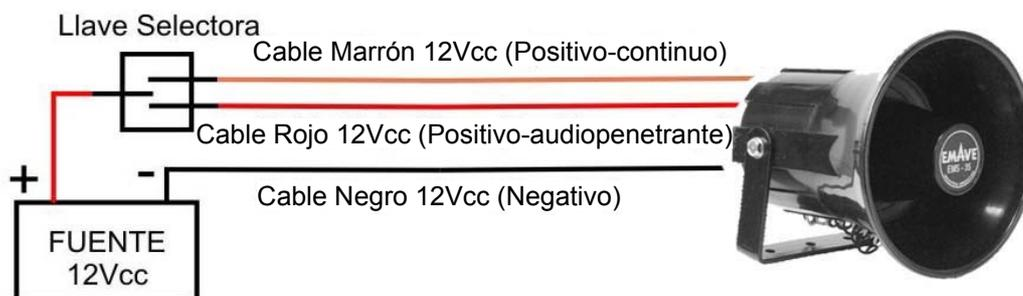
La sirena EMAVE dispone de TRES (3) cables externos, uno (1) rojo, uno (1) marrón y uno (1) negro para la conexión de la alimentación de 12V de corriente continua. El cable negro se conecta al negativo de la alimentación. Luego de acuerdo a cuál de los otros cables se conecte al positivo de la alimentación es el sonido que emitirá la sirena. Si se conecta el marrón será continuo, si se conecta el rojo será audiopenetrante.
